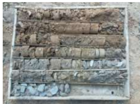
Slika 4. Nabušena jezgra iz bušotine B-1
