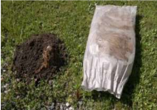
Slika 7. Dehidrirani mulj nakon obrade na modulu sa filter vrećama
