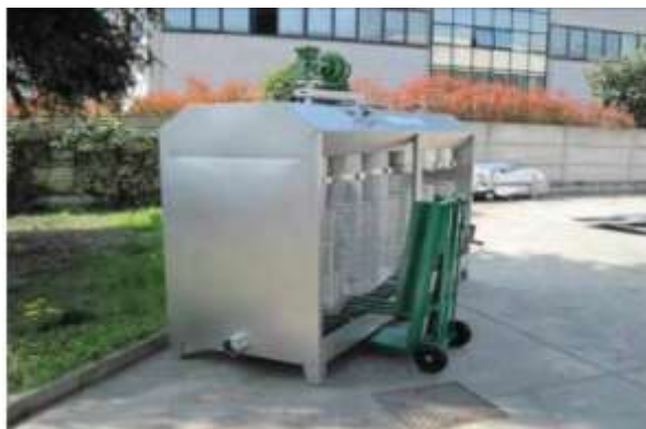
Slika 2. Sistem za obradu mulja pomoću filter vreća
