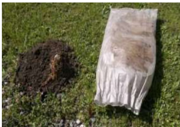
Slika 1. Dehidrirani mulj nakon obrade na modulu sa filter vrećama
